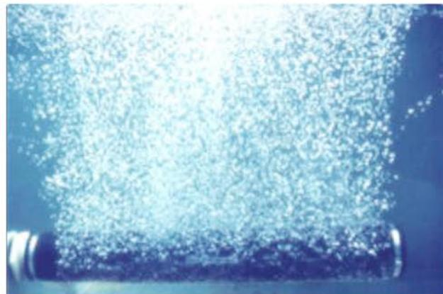
دیفیوزرهای لوله ای حباب درشت OXYO™ به منظور اختلاط موثر در حوضچه های متعادلسازی کاربرد دارد . اگر چه به این طریق هوادهی هم در داخل مایع انجام می پذیرد ولی به منظور هوادهی موثرتر پیشنهاد می گردد در حوضچه های هوادهی و مخازن پرورش ماهی از انواع دیفیوزر های حباب ریز OXYO™ استفاده گردد .
