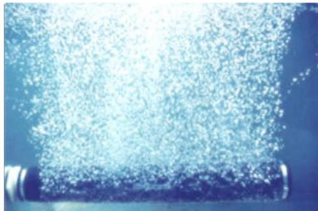
دیفیوزرهای لوله ای حباب درشت OXOXO™ به منظور اختلاط موثر در حوضچه های متعادلسازی کاربرد دارد . اگر چه به این طریق هوادهی هم در داخل مایع انجام می پذیرد ولی به منظور هوادهی موثرتر پیشنهاد می گردد در حوضچه های هوادهی و مخازن پرورش ماهی از انواع دیفیوزر های حباب ریز OXOXO™ استفاده گردد .
